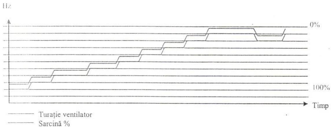
Există o corelație între reglarea ventilatorului secundar și reglarea stocherului.
